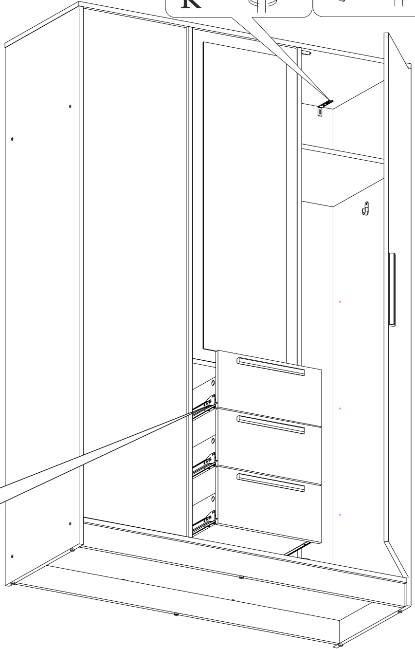
Схема крепления к стене , через уголок Овербаланс (К)
